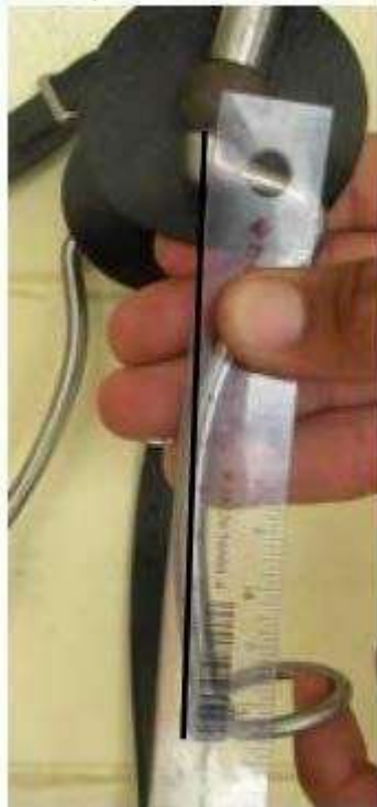
Como medir la pata del freno con argollas flexibles
